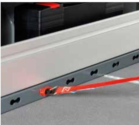
An der Ladungssicherungsschiene einklippbare Spanngurte und an den Rahmenständen zu befestigende Zubehörteile machen das System noch wertvoller.
